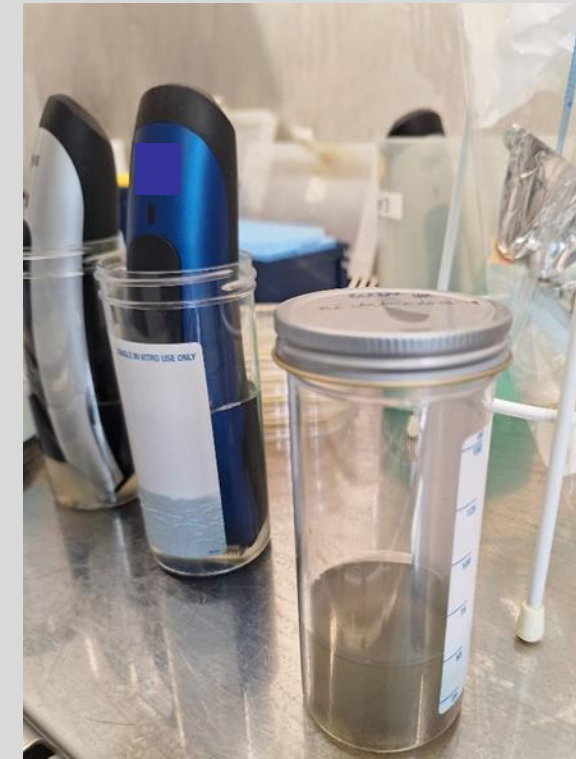
Sichtbare Kontamination mit Haaren und Hautpartikeln trotz Vorreinigung
