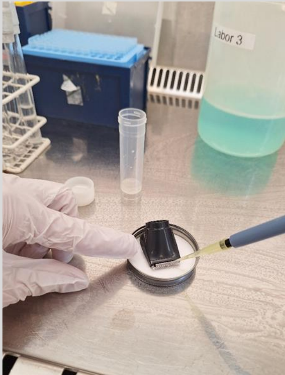
Kontamination der Schneideinheit → Suspension läuft ins Gerät
