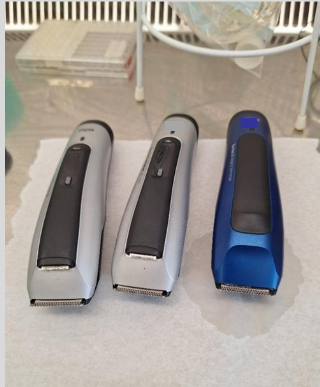
Geräte ohne abnehmbaren Aufsatz wurde am Testtag gereinigt und mittels Wischdesinfektion desinfiziert (Geräte nicht vollständig getrocknet vor Testbeginn)
